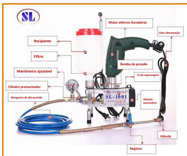
Foto: Equipamento de injeção por alta pressão
