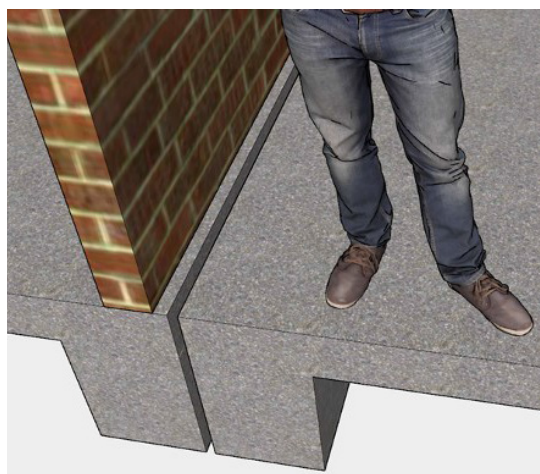
Ilustração: Junta de dilatação no meio do pano de piso Fonte: GTI Projetos – Arqª Camila S. Grainho
