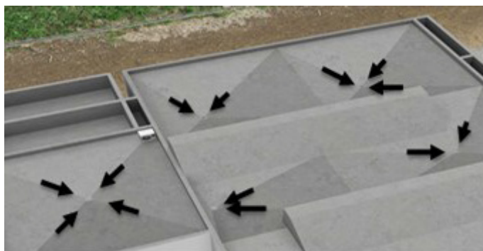
Ilustração: Execução de caimento/regularização de piso
