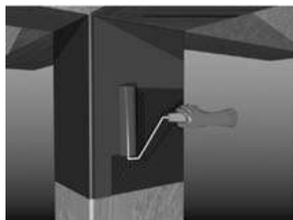
Figura 3.11 – Aplicação do revestimento protetor.
