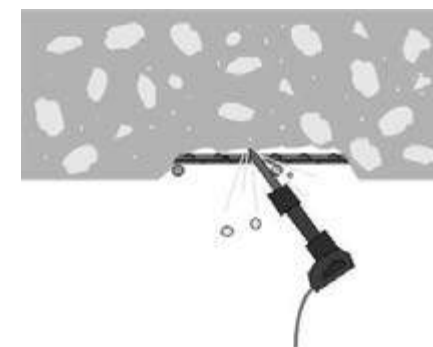
Figura 3.1 – Remoção de superfícies degradadas.
