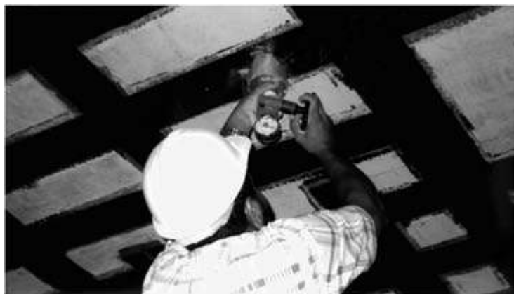
Fotografia 9.14 – Teste de arrancamento do sistema composto aplicado.
