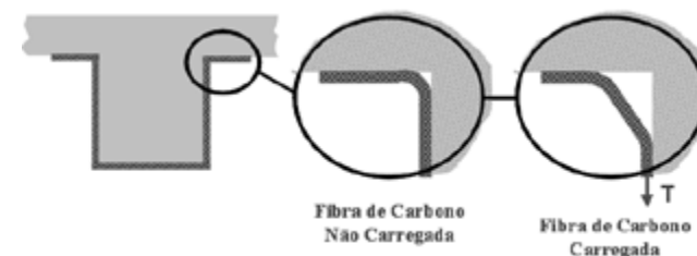
Figura 8.11 – Comportamento do sistema CFC em cantos internos.
