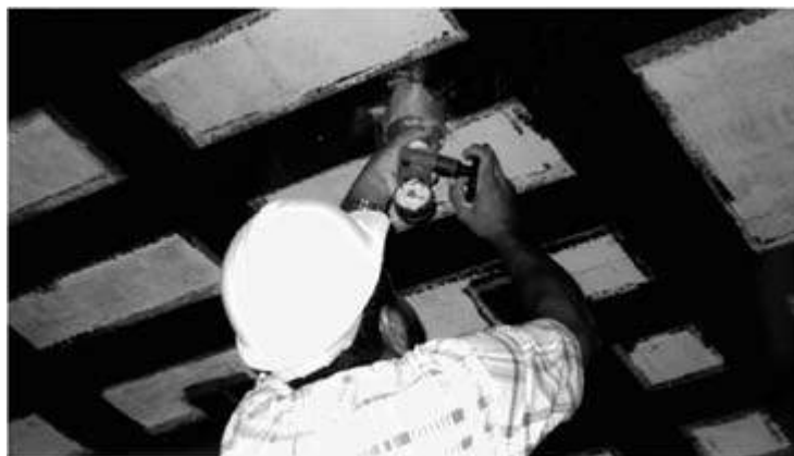
Fotografia 9.14 – Teste de arrancamento do sistema composto aplicado.
