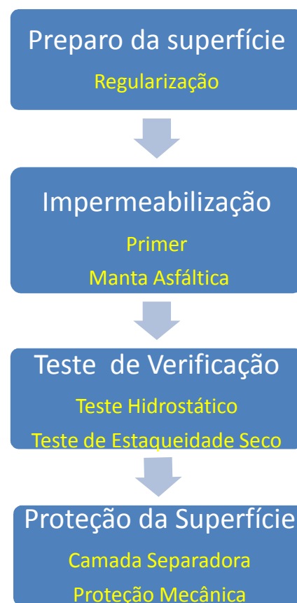
Figura 3: Etapas da impermeabilização com manta asfáltica com maçarico.
